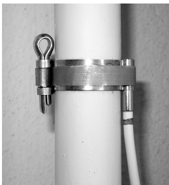
Obr.12 Uchycení příložného teplotního čidla k trubce
