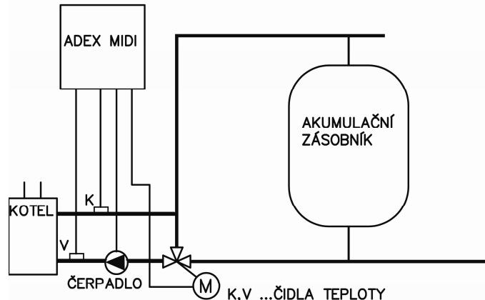
**Zapojení MD1b** pro regulaci kotlového okruhu v rozvětvené soustavě s anuloidem ↓
