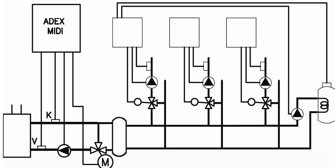
Zapojení MD1a se používá pro regulaci nabíjení akumulační nádrže v systémech s kotlem na tuhá paliva. Zapojení MD1b je určeno pro teplotní ochranu kotlů v systémech bez akumulační nádrže.
