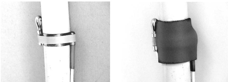
Teplotní čidla se přikládají na čistou trubku podle obrázku. Pomocí upínacích pásků je nutno zajistit dostatečný tepelný kontakt mezi čidlem a potrubím. Přelepení termoizolační páskou zajistí menší ovlivnění měření okolní teplotou.
