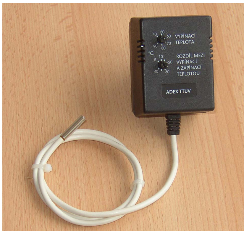
obr. 1 Rozsah nastavení diference mezi vypínací a zapínací teplotou
